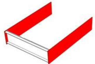
С помощью конфирматов прикрутите две детали №5 к детали №3. Таким образом мы получили основание шкафа.
