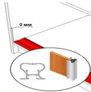
Нижняя направляющая сдвинута относительно верхней в глубину проема шкафа на 18 мм при использовании асимметричных профилей-ручек
