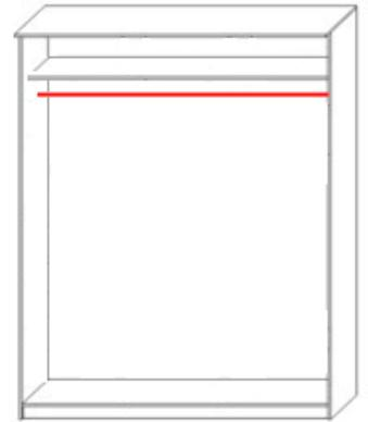
Убедитесь, что деталь №1 и №3 относительно стоек находятся под прямым углом. Это можно проверить угловой линейкой или замерить диагонали шкафа, они должны быть одинаковыми.
