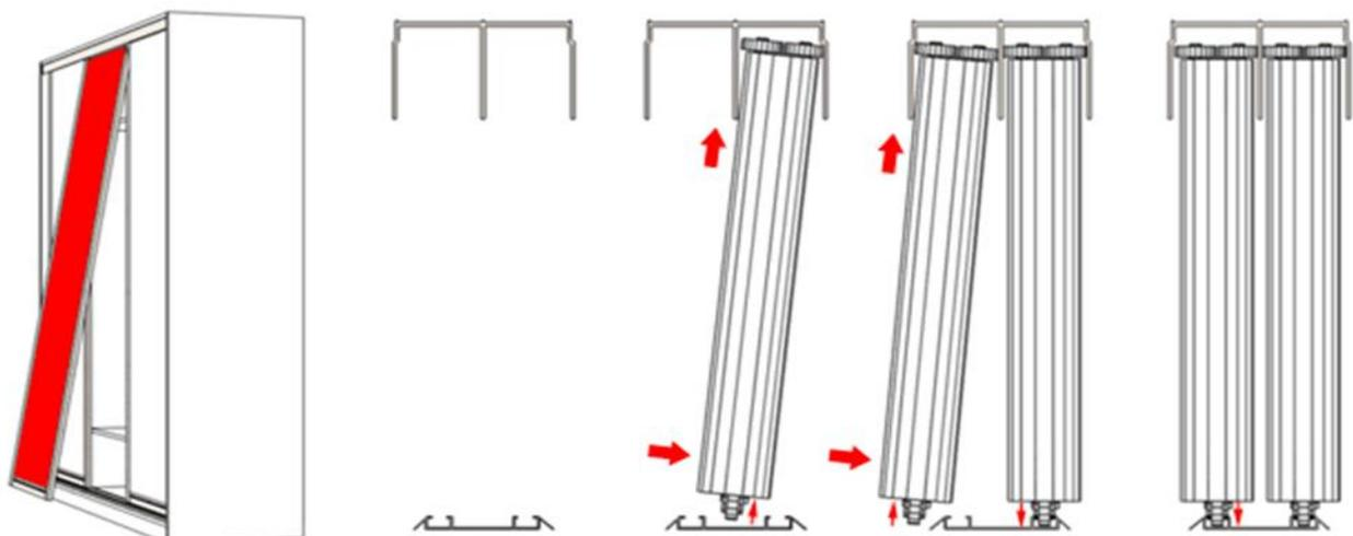
Заводим верх двери в нужный паз верхней направляющей до предела и устанавливаем колесами роликов в паз нижней направляющей, опустив дверь.
