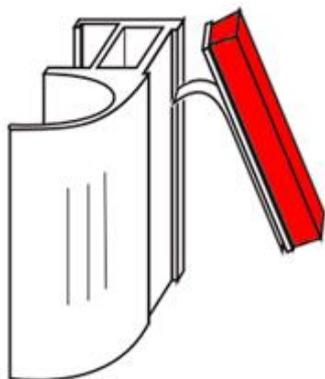
После регулировки дверей производится установка шлегеля. Аккуратно снимите защитную пленку с клеевой основы на 4-5 см и приклеивайте сверху вниз постепенно снимая защитную основу.
