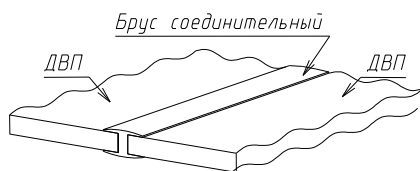
Схема соединения брусом соединительным (поз.16, 17) стенок задних из ДВП (поз.14)
